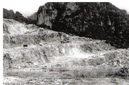
ภาพที่ 2 การทำเหมืองแบบขั้นบันได ที่มา: สำนักนโยบายและวางแผนสิ่งแวดล้อม, 2001
